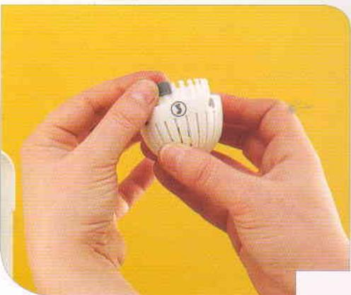
**4.** Для блокировки полного закрытия вставьте скобу ограничения в паз, находящийся левее желаемого значения.
